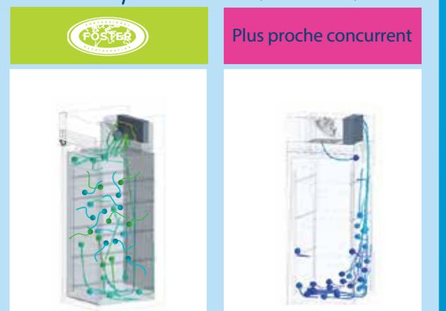
> Les résultats du SNFD montrent avec précision la circulation d'air ainsi que de la température au sein de l'armoire. Les graphiques indiquent donc que la répartition de l'air dans l'armoire G2 est optimale, délivrant une température homogène dans l'enceinte\*, permettant de réduire l'énergie dépensée.
